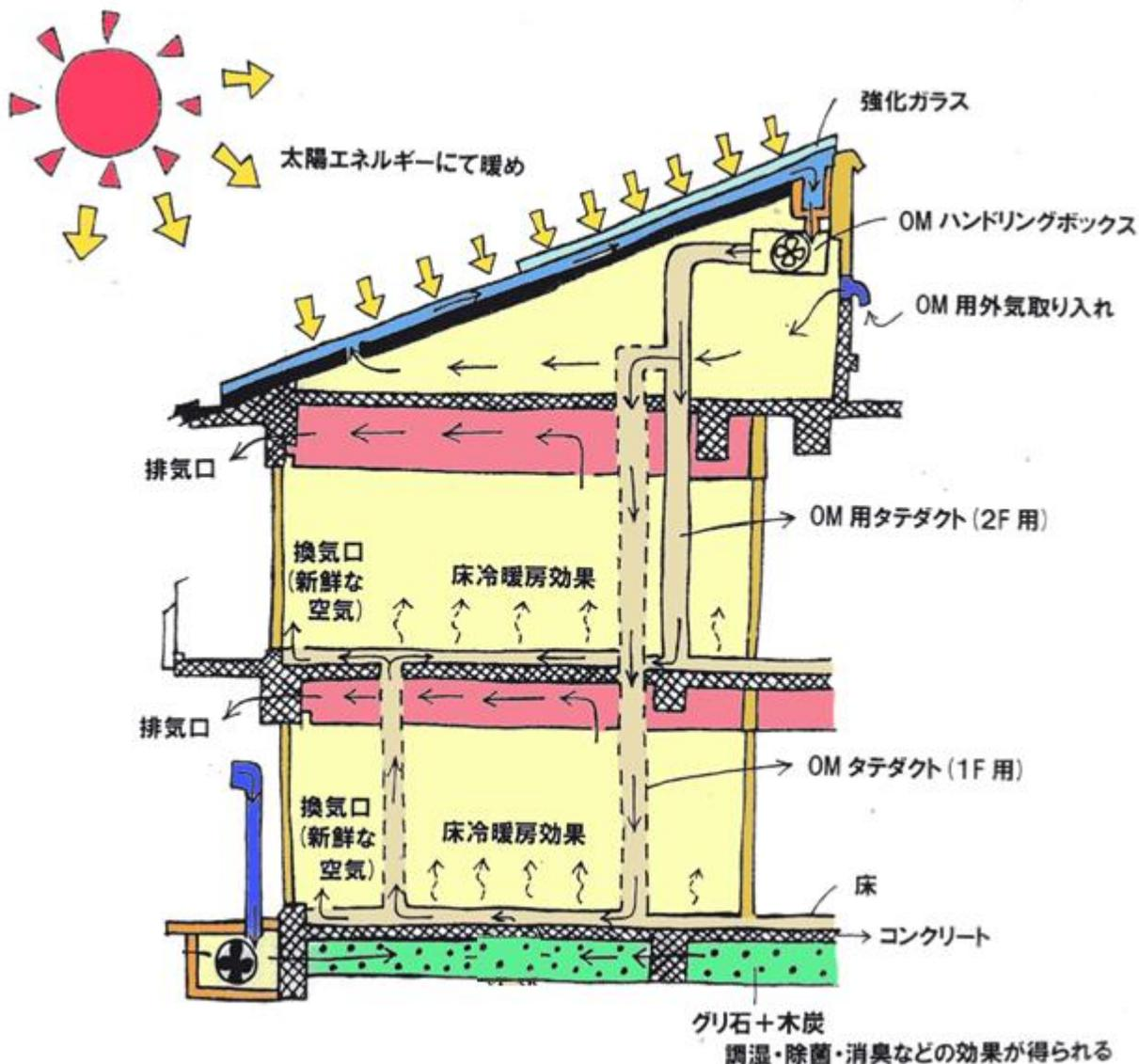
◆修熱空気が一定の温度（室温+10℃）に達する唯一の機会箱であるハンドリングボックス内にあるファンが回りだして、季節に合わせて、冬には床下に送って床暖房に利用したり、夏の昼間には外に排出して屋根からの輻射熱を押さえたり、夜には夜間冷気取り込みを利用したりします。
